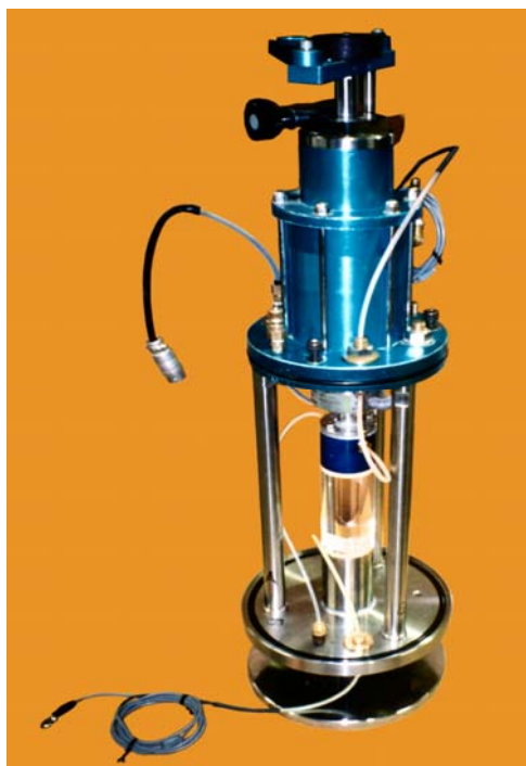
写真は三軸室にバンダーエレメントが組み込まれたものです。
